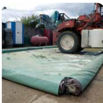
Cette aire de rétention est idéale pour le remplissage, la vidange et le nettoyage des pulvérisateurs. Totalement étanche, ce bassin se vidange facilement à l'aide d'une pompe (option). L'aire est composée de boudins de mousse amovibles afin de faciliter la manutention et le rangement ainsi que de deux passages de roue. Un géotextile de protection complète le dispositif.
